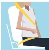
**4. El asiento y el reposacabezas complementan el cinturón.** El “efecto submarino” –el cuerpo del ocupante se desliza por debajo de las bandas del cinturón puede evitarse si el respaldo del asiento no está demasiado reclinado.
